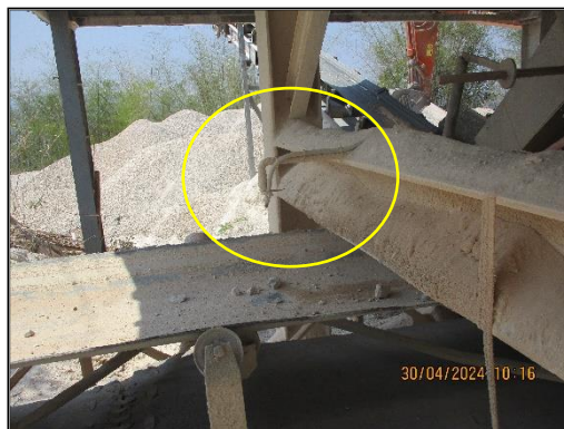
ภาพที่ 2.16 การติดตั้งระบบสเปรย์น้ำบริเวณจุดกำเนิดฝุ่น
